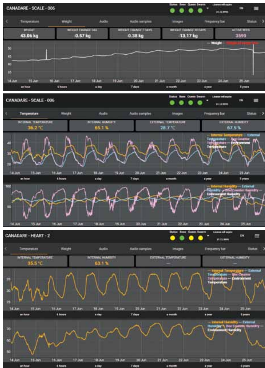
Prikaz različnih meritev senzorjev, ki jih uporabljamo v okviru projekta BEEDIVERSITY. Podatki s senzorjev so zajamani na 10 minut.
